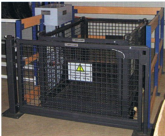
Förderkorb mit einflügeliger Drehtür sowie einflügeliger Geschoss-Drehtür (hier im geschlossenen Zustand)
